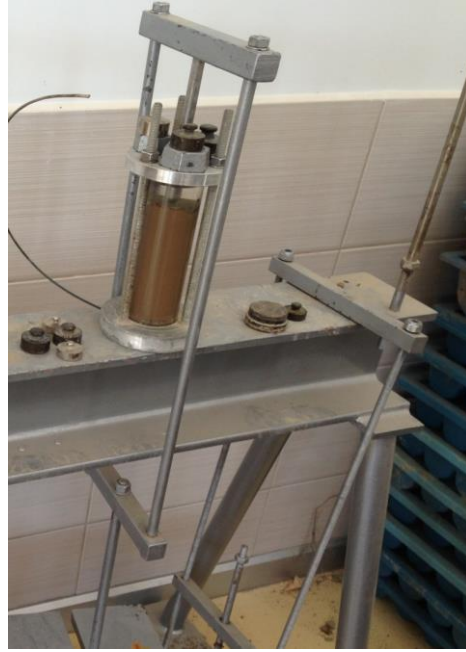
Şekil 8. Numunelerin bulamaçtan 100 kPa düşey gerilme altında yeniden oluşturulması
